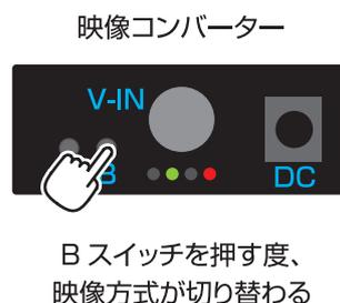
B スイッチを押す度に NTSC⇔PAL と映像方式が切り替わりますので、ひずみなく正常に表示されるバックカメラ映像を選択し、設定してください。
